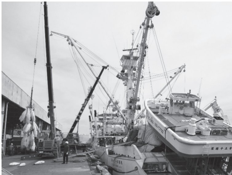
図-13 本船船尾に搭載されたレッコボートと巨大なパースウインチ
