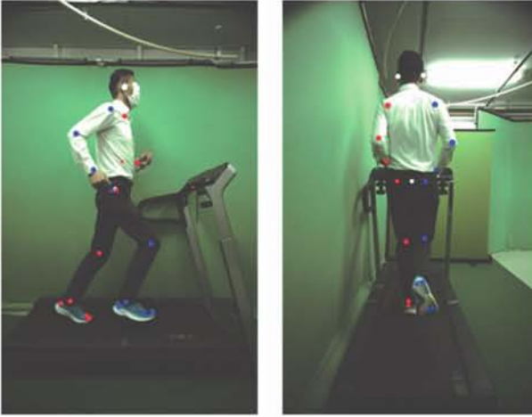
図5 OpenPoseによるキーポイント検出結果
