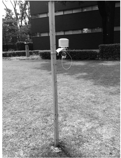
図3 おんどり (TR52i) の設置状況 センサー部分は自然通風式シェルター内に入っている。
